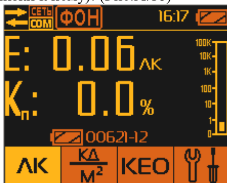
Рис.А.10. Показания люксметра после вычитания фона без включения источников света.
