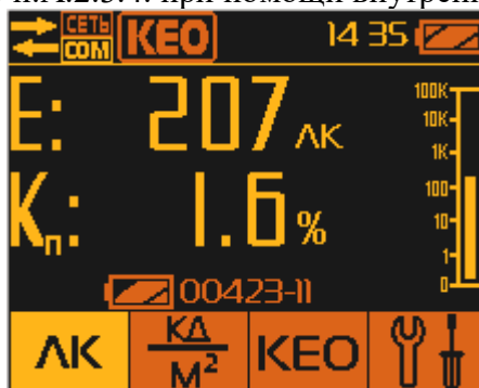
Рис.А.21. Измерение освещённости с КЕО.
