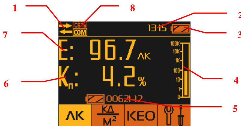
Рис.А.3. Режим измерения освещенности и коэффициента пульсаций.
