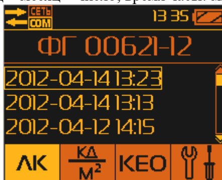
Рис.А.14. Индикация сохраненных в памяти БОИ-01 трёх сессий, измеренных с помощью ИГ ФГ-01 с заводским номером № 00621-12.
